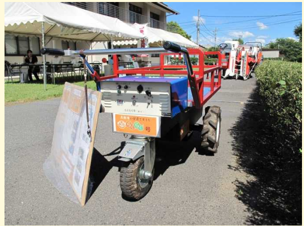
資料：開発した柿果実運搬のための電動農作業車 提供：科学技術振興機構 社会技術研究開発センター
